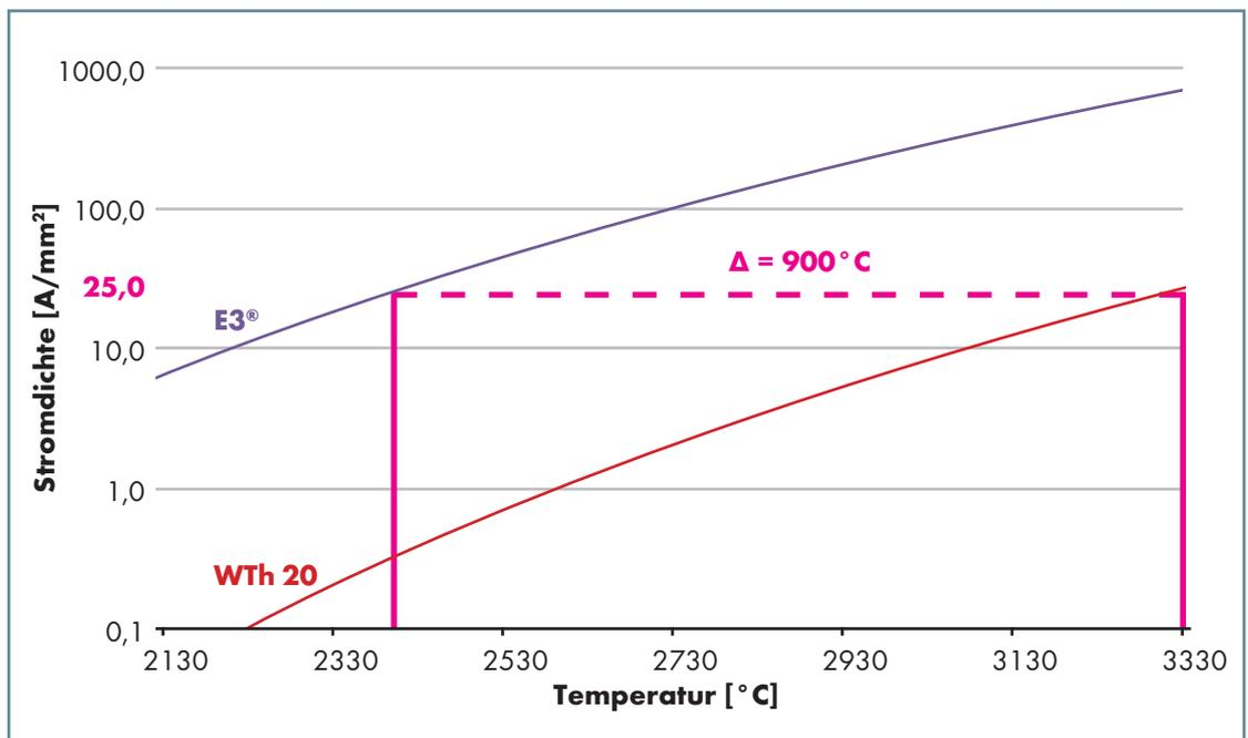
Bei gleicher Stromdichte bleiben die E3®-Elektroden ca. 900 °C kälter als die WTh-Elektroden und sind somit weitaus höher belastbar.
